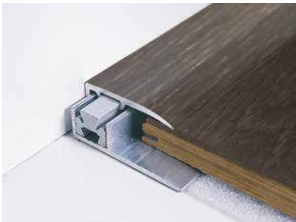
Perfil patentado para bordear perimetralmente pavimentos que necesitan dilatación porque gracias a la cavidad interna de 16 mm, permite un movimiento de los pavimentos inferiores de más de  $\pm 5$  mm. Evita el uso del rodapié, garantizando la dilatación y la fijación perimetral del suelo. También se puede utilizar como delimitación de las brújulas para felpudos y en correspondencia con las puertas correderas.
